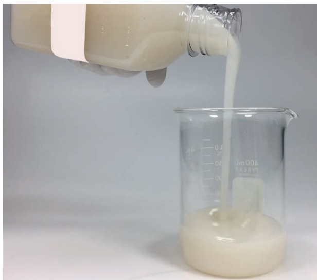
Abb. 1 Durch Fermentation gewonnene Cellulose ist gebrauchsfertig und ohne Einstellen des pH-Werts oder Mischen mit hohen Scherkräften funktionsfertig. Abhängig von der Formulierung und dem zu stabilisierenden Produkt liegt die Anwendungskonzentration im Bereich von 0,5 % bis 5 %.
